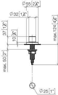
Accionamiento excéntrico manual con maneta de control giratoria - Latón cepillado (Oro 23k)
